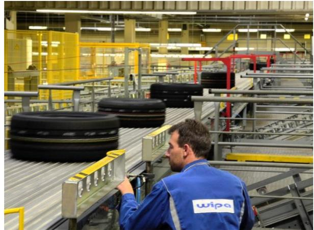
Auf fast 400 Meter erstreckt sich die von WIPA konstruierte Förderbandanlage für die Reifeninspektion.
